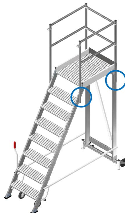
7. MONTARE I CORRIMANI, AVVITANDOLI ALL'ESTERNO DEI MONTANTI DELLA SCALA DI SALITA E AI PIATTI INSTALLATI SUL PARAPETTO (CERCHI BLU), TRAMITE LE VITI IN DOTAZIONE.
