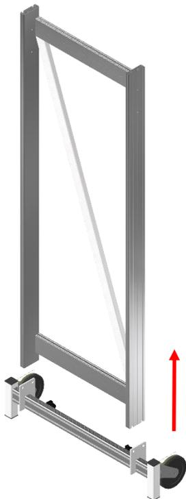
2. MONTARE IL POSTERIORE SOTTO LA PEDANA, AVVITANDOLO ALLA PIASTRA APPLICATA SULLA PEDANA (CERCHIO BLU), TRAMITE LE VITI IN DOTAZIONE.
