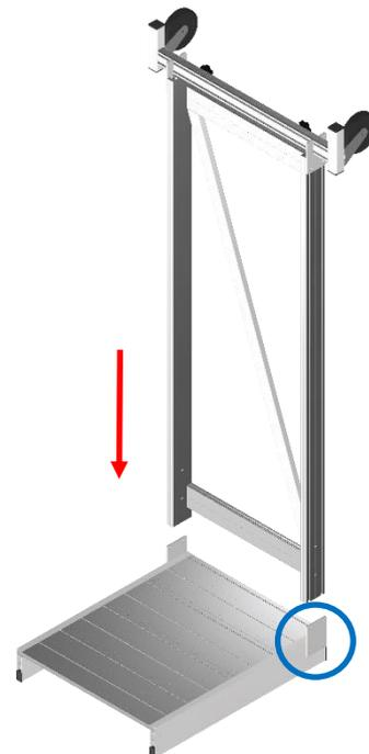
3. MONTARE LA SCALA DI SALITA SULLA PEDANA, INSERENDO LA FUSIONE A 60° NEL PROFILO DEL PARAPIEDE (CERCHIO BLU), TRAMITE LE VITI IN DOTAZIONE.
