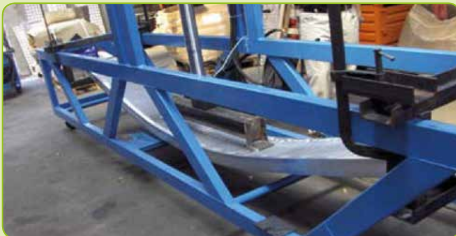
Rampa sottoposta a rottura.
